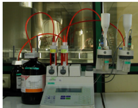
Fig.4. Dosage électrochimique de H 2 O 2 par le permanganate de potassium.
